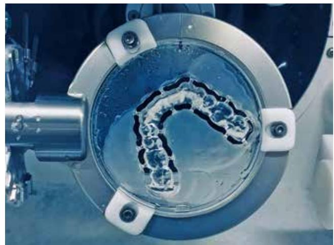
**Abb. 2:** Aus dem eingefüllten und gehärteten reBlanX® herausgefräste Schiene.
