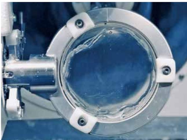
**Abb. 1:** Der aufgefüllte Blank direkt aus dem Drucktopf, blasenfrei und absolut hochtransparent.
